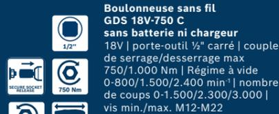
**Boulonneuse sans fil GDS 18V-750 C sans batterie ni chargeur**
